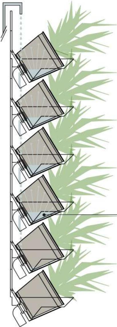
Die Pflanzenelemente wurden so entworfen, dass jede einzelne Pflanze mit einer abgemessenen Menge an Wasser versorgt wird und die Pflanzen nicht um Wasser konkurrieren.
